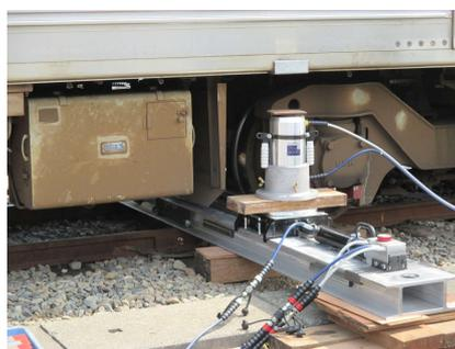
万が一脱線した場合に迅速に対応できるよう、脱線復旧設備を備えております。
