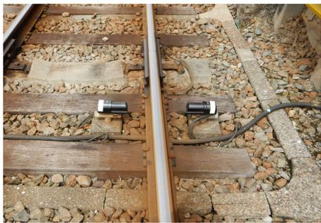
線路に人が転落した場合など、センサーで自動的に検知して接近してくる列車に異常を知らせるセンサーです。
